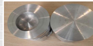
车偏心燃烧室 - 高精密数控车床
